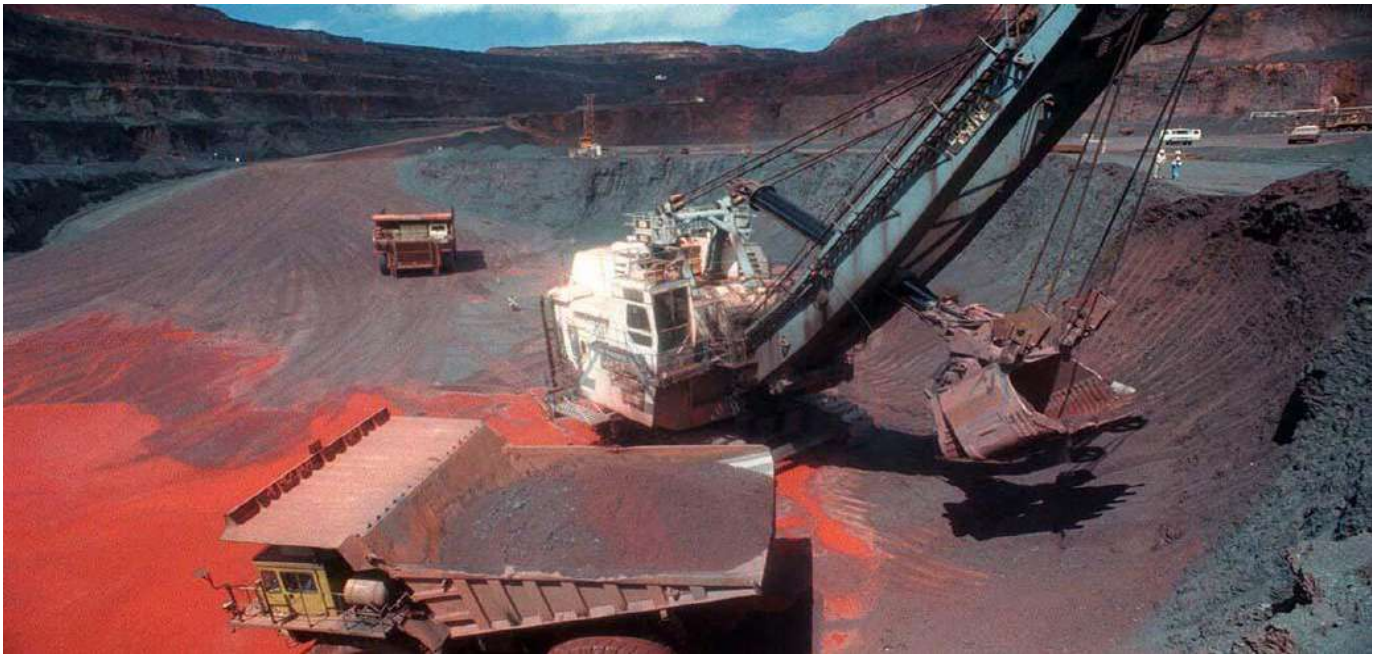
Foresta Amazonica Vale S.a. Carico Camion di trasporto presso lo stabilimento di frantumazione del minerale di ferro di Carajás (PA)
